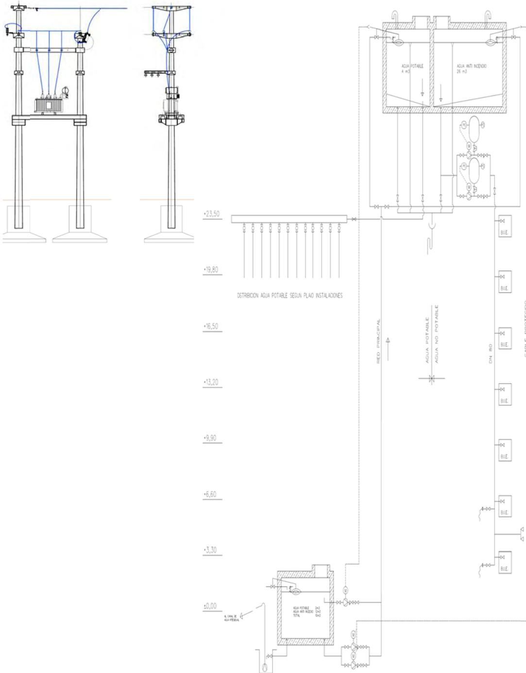
típico poste de distribución (arriba izq.), diagrama de agua y desagüe
